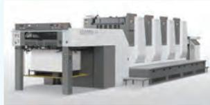
新しく増設された印刷機「リスロンA37」は、UV乾燥装置を搭載しており、インキを瞬時に硬化させることで表面加工など後工程の作業性を大幅に改善し更に納期短縮を実現させます。
